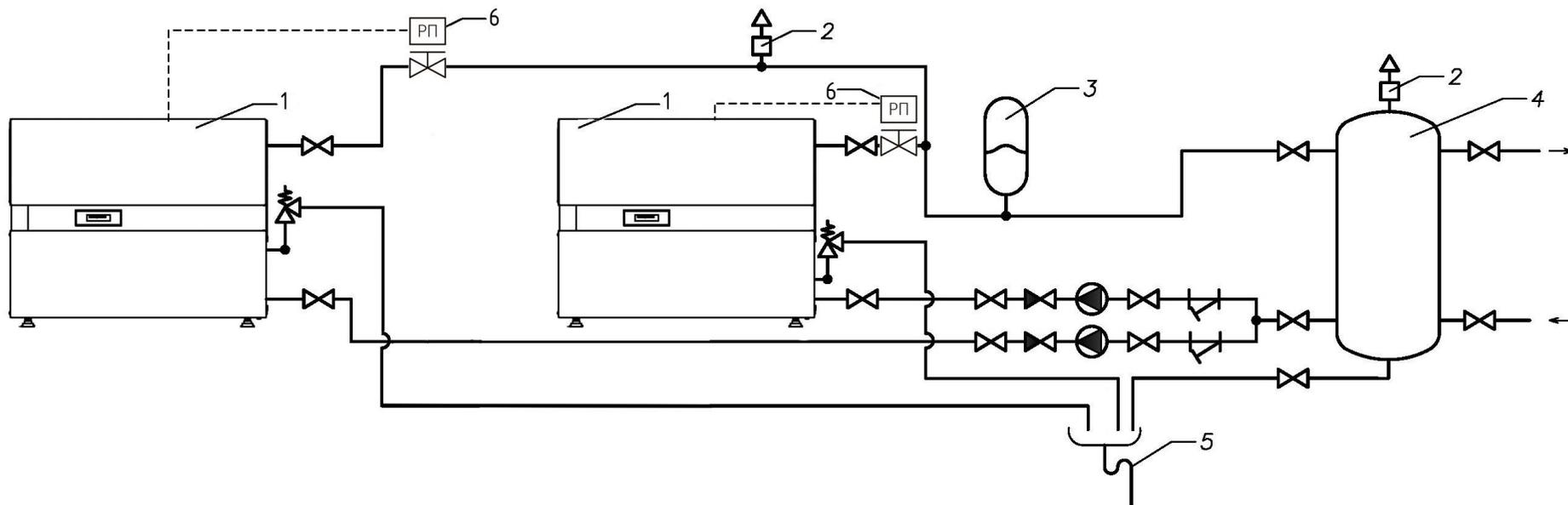
**Рис. 4 Упрощенная схема подключения водонагревателя в систему водоснабжения.**
